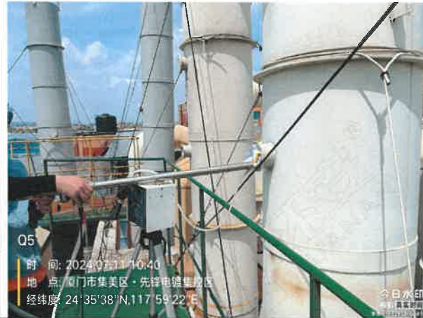
酸雾废气 DA007 出口(点位:◎7)
